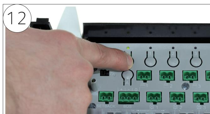
Avsluta inlärningen genom att trycka på L-knappen varpå L-LED släcks.
