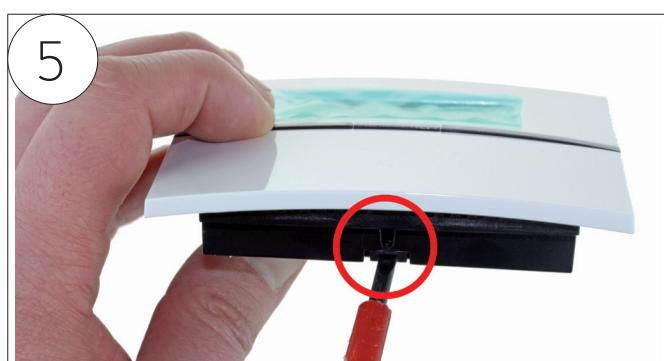
Ta bort termostatens bakstycke genom att trycka in låsningen med hjälp av skruvmejsel eller motsvarande.
