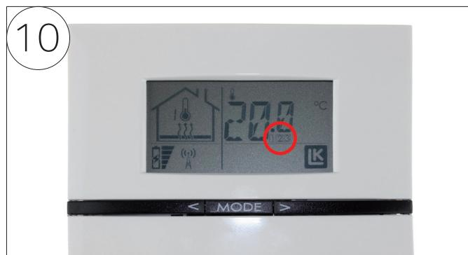
Kontrollera att valda kanaler visas i termostaten. Bekräfta med *Mode*. Termostaten växlar till normalvy.
