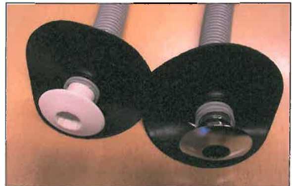
Figur 3.12: Mansjett tilhørende avløp/drenering fra fordelerskap. Utvendig diameter 97 mm. Hulldiameter 17 mm.
