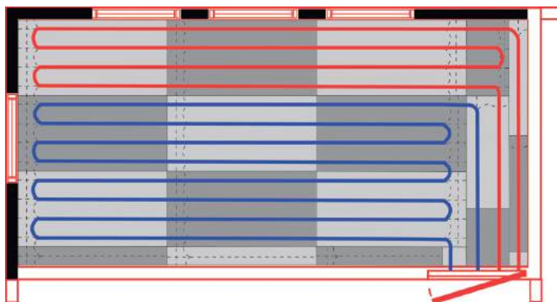
Exempelbild. Bilden visar testläggningen med rörslingorna.
