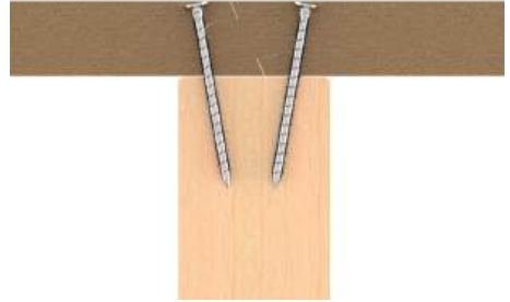
Skruvning av HeatFloor 22 i golvregel.
