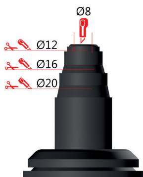
Kapning av rör genomföring.
