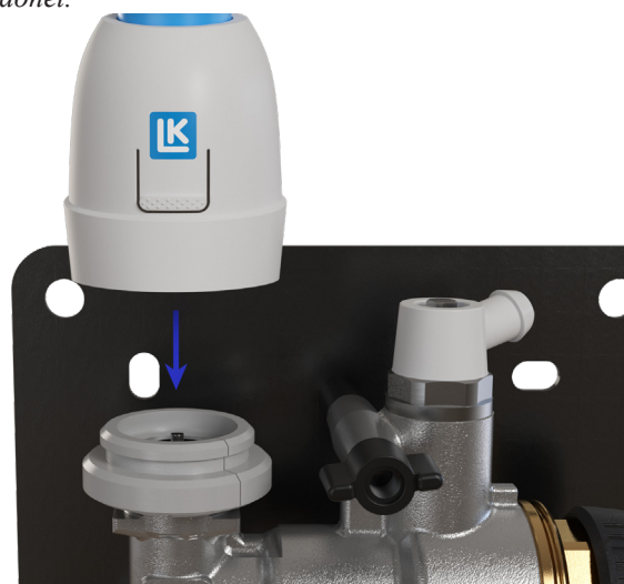
Steg 4: Montera ställdonet på den grå adaptern. Ett klick hörs när adaptern sitter rätt monterad.
