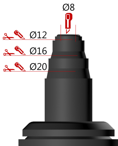
Kapning av rör genomföring.
