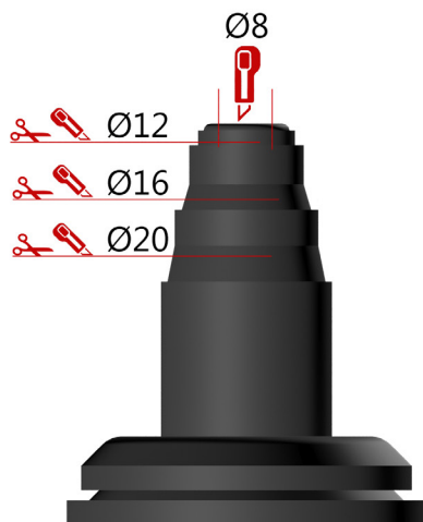
Kapning av rör genomföring för golvvärmerör.
