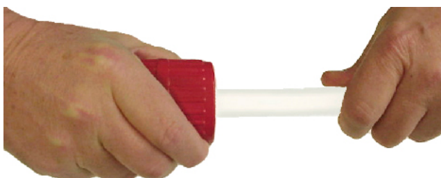
LK PE-X Universälrrör gradas med rörfräs.
