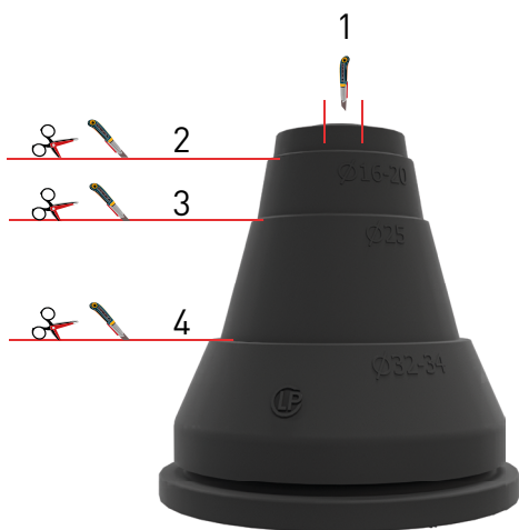
Kapning av LK Rör genomföring 20-25 LP.
