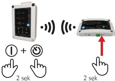
Innlæring av lekkasjedetektor.
