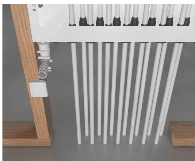
Dreneringsbend direkte koblet mot skapets utløpsstuss
