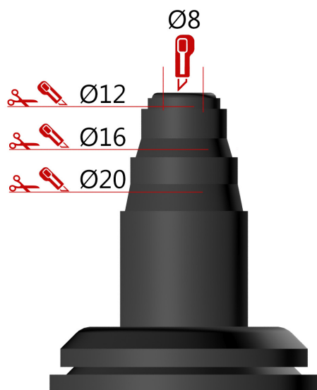
Kapping av rørgjennomføring.
