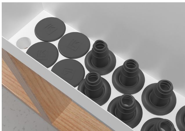
Asenna putkiläpiviennit ja tiivistetulpat
