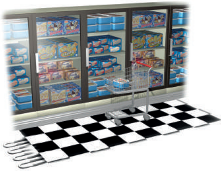
Golvvärme med spillvärme från kylanläggning.
