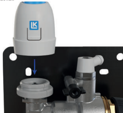
Steg 4: Montera ställdonet på den grå adaptern. Ett klick hörs när adaptern sitter rätt monterad.
