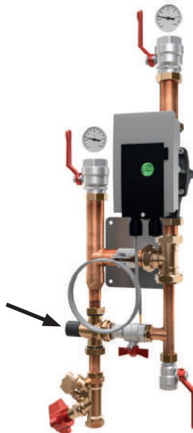
LK Shunt 2/3. Gänga av handratten och ersätt den med ventilställdonet.
