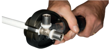
Pressning med pressback.
