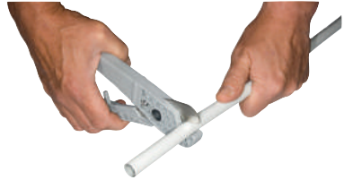
Kapning med rörsax.
