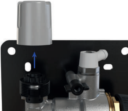
Steg 1: Demontera den grå handratten.
