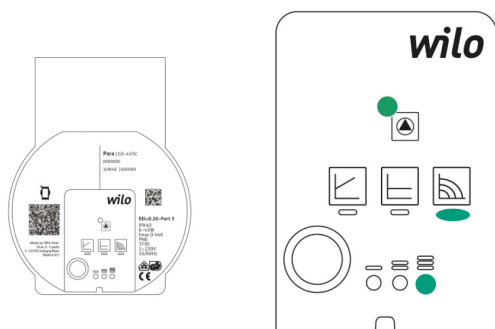
Wilo Para 25-130/6-43 SC display med fabriksinställd display.
