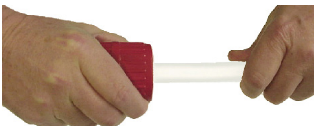
LK PE-X Universalrör gradas med rörfräs.
