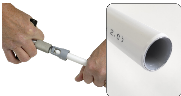
LK PAL Universalrör kalibreras och gradas med LK PressPex Kalibreringsverktyg F9.
