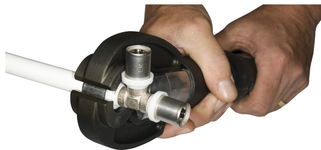
Pressning med pressback.
