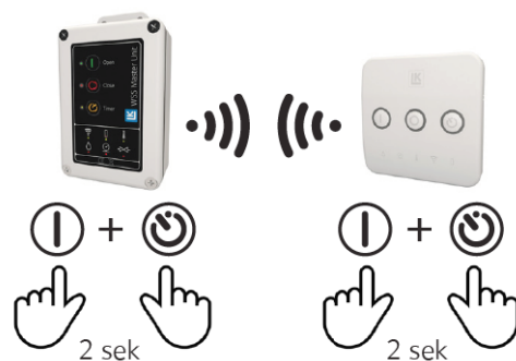
Inläring av manöverpanel.
