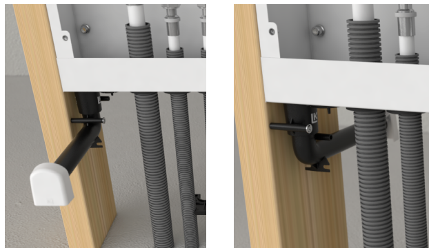
Principbild. Dränageböj direktansluten mot skåpets utloppsstos mynnar i samma rum som skåpets serviceöppning.
