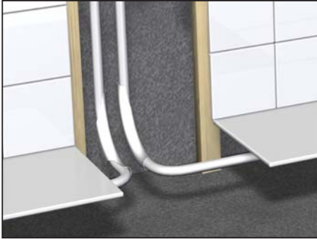
Bild 7. Montering av LK Rörböjningsstöd.
